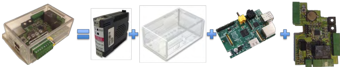
Figura 2. Componentes de un LC-DAQ-Node. (precio estimado 120 €, incluida la Fuente de alimentación 15W y la tarjeta SD 8GB).
